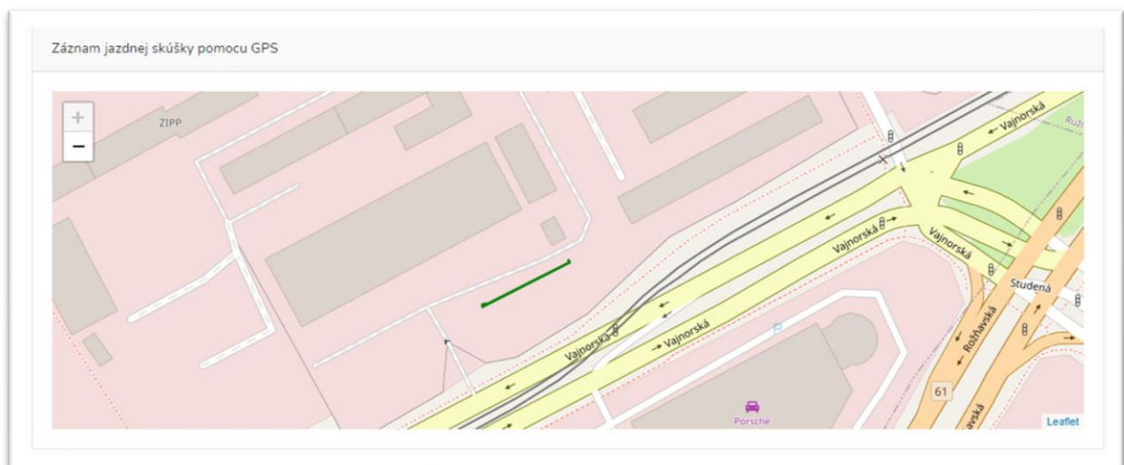
Obr. 10 – Grafický záznam prejdeného úseku počas jazdnej skúšky vozidla pomocou zaznamenaných GPS súradníc vo webstránke aplikácie TESTEK expert. Súradnice GPS slúžia iba na zdokumentovanie miesta a oblasti merania, nie na výpočet výsledkov jazdnej skúšky (zbrzdenia a spomalenia). Na vyhodnotenie výsledkov merania slúžia dáta z akcelerometra smartfónu.
