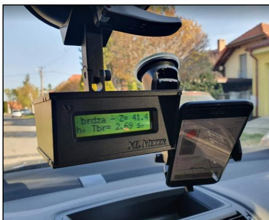
Obr. 4 – Meranie pomocou mobilnej aplikácie je možné bez nutnosti vopred nastavovať jedinú správnu polohu – nivelizovať mobilné zariadenie, presnosť merania poloha telefónu neovplyvní. Vľavo XL meter, vpravo mobilné zariadenie.
